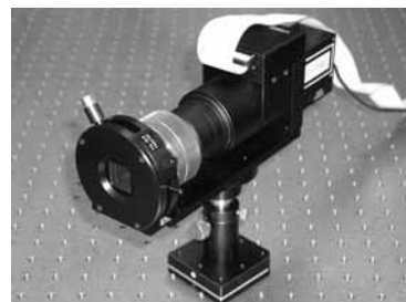
図1 空間光変調器(プログラマブル位相変調ユニット: 浜松ホトニクス製X7550DB-14L)
