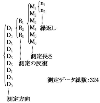
図6 ステップゲージ測定の順序
