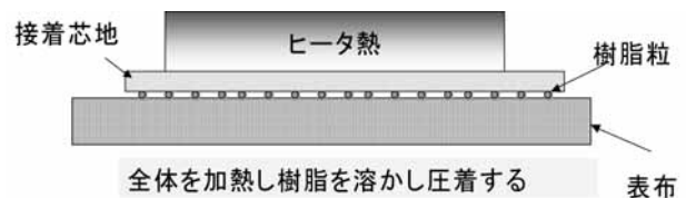
図1 輻射熱による接着芯地の接合
