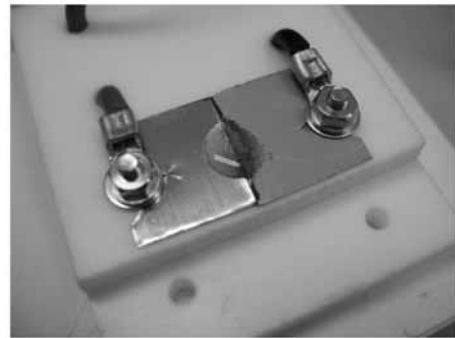
図1 電解腐食促進実験における接触反応部分の拡大図
