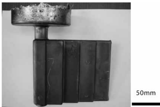
図1 多段型鑄物の外観および断面のマクロ組織
