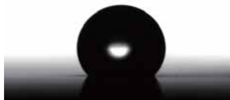
図5. OTS/Toluene溶液 (2.4mM) に5分間浸漬した鉄基板の水接触角の実測例 (OTS-5min)
