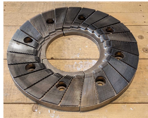
写真 2 CNF 製造用に開発されたプレート
