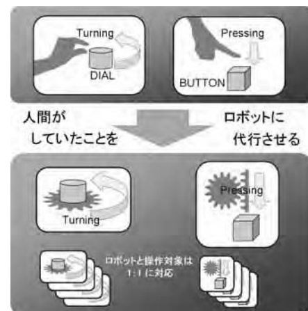
図1 単機能ロボットによる操作自動化の概念
