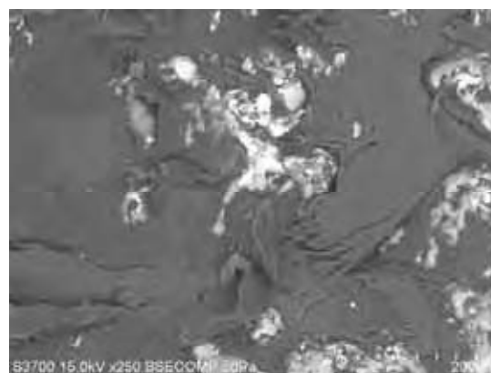
図2 現行品表面SEM画像 (白色部が金属、グレー部がフッ素樹脂)
