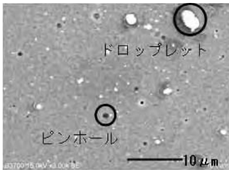
図2 コーティング表面の欠陥（一例）
