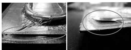
図5 環境試験後のパネル裏面の剥がれ
