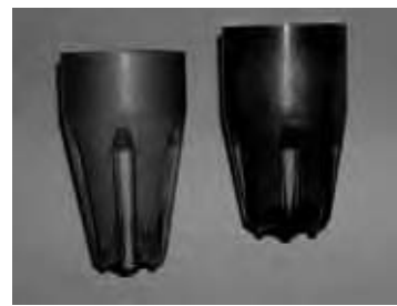
図3 摩擦試験片の例（左：低摩擦、右：高摩擦）
