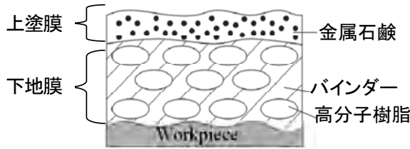
図1 2液2層型潤滑皮膜の構造概念図
