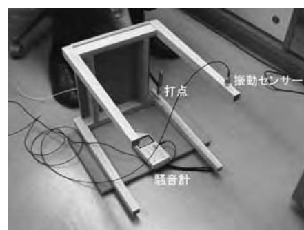
図2 インパルスハンマによる打音検査
