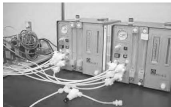
図1 におい成分ガス供給システム
