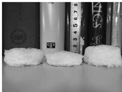
写真2 音響計測用にカットした開発した吸音材料
