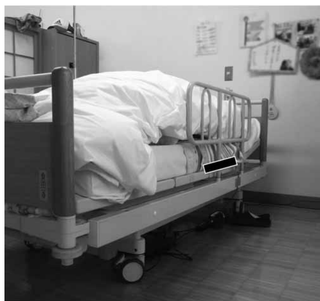
写真2 特別養護老人ホームでの検証実験状況 被験者のマットレス下、胸部付近にセンサシートを設置（図中黒部）
