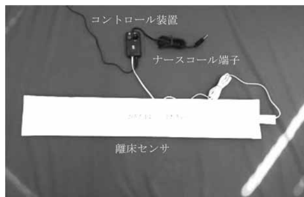
写真1 実証試験で用いた開発した離床センサ（1本使用時）
