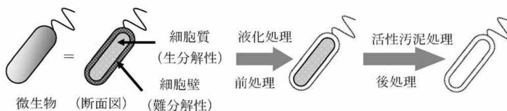
図2 余剰汚泥減容化の仕組み
