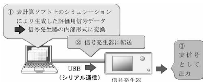
図2 信号発生器を利用した評価用信号生成システムの構成
