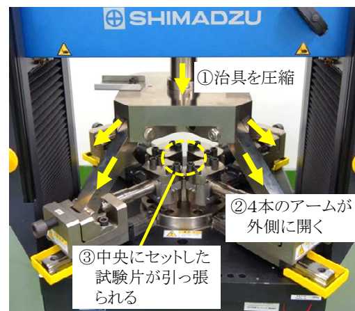
図 2 二軸引張試験の概観
