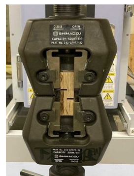
図2 引張りせん断試験
