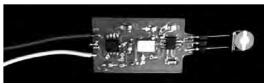
写真4 差分検出回路（1チャンネル分）
