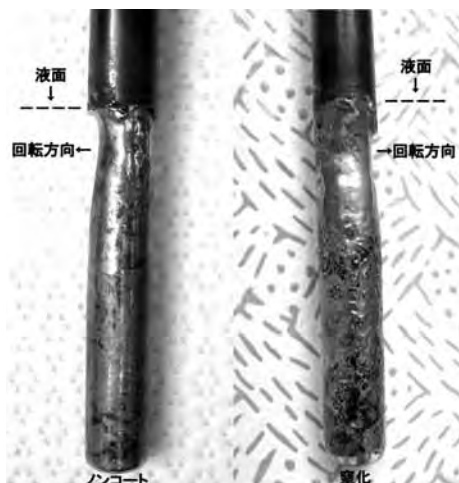
図4 2h試験後のTP (ノンコート、窒化)
