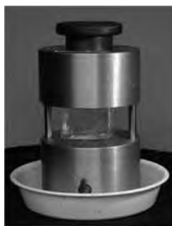
図1 氷溶解型成型器「アイスマールド」
