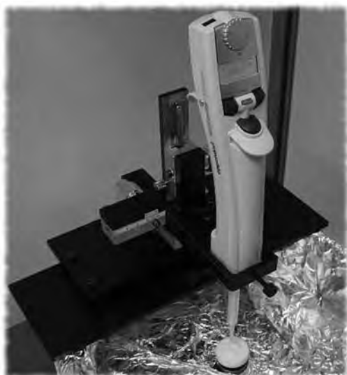
図2 液滴下位置固定用治具
