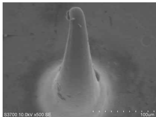
図.1 Ni電鍍針 長さ500 \mu m SEM観察像
