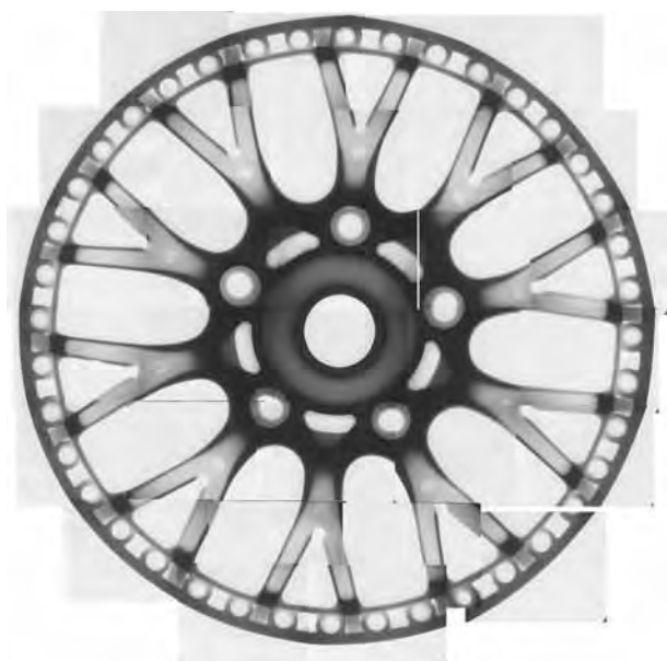
図12 18インチホイールディスクのX線写真
