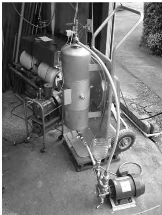
図4 密閉循環型汚泥可溶化装置（改良機）
