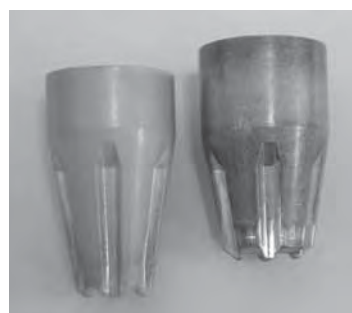
図2 試験後の摩擦試験片の例（左：低摩擦、右：高摩擦）
