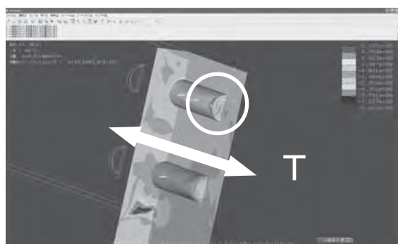
図5 ダボ接合部の応力集中箇所
