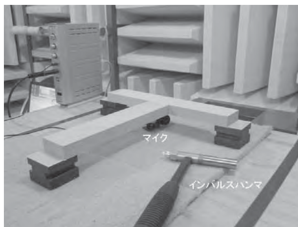
図1 インパルスハンマによる打音検査
