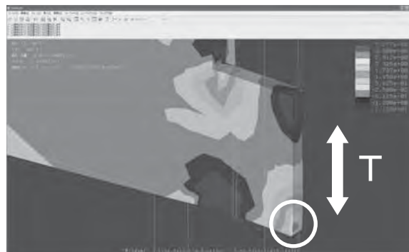
図6 ホゾ接合部の応力集中箇所
