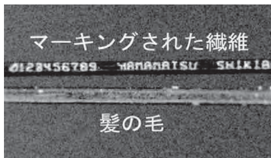
図2 ポリエステル繊維 (0.1mm) への微細マーキング (0.06mm)
