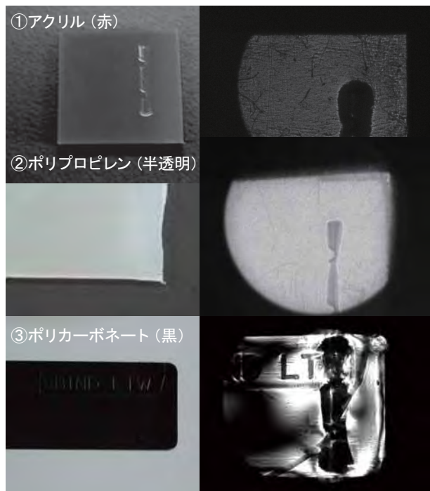
図2 A：光弾性実験に用いた試験片（図左側）とB：その試験片における近赤外領域での光弾性実験による測定結果（図右側）。
