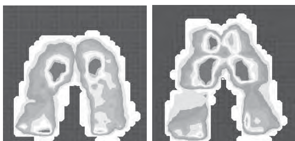
図3 バックサポートによる体圧分布の違い (左は無し、右は有り)
