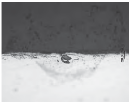
図1 白色生成物発生箇所断面の金属顕微鏡画像
