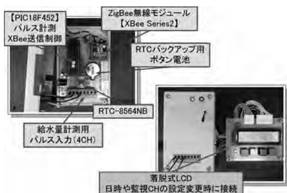
写真3 充放電コントローラ&amp;中継デバイス
