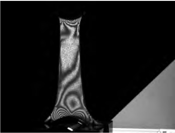
図2 コンロッド模型の圧縮時の光弾性実験による観察像
