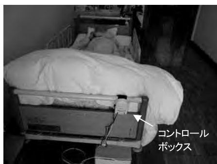
図9 特別養護老人ホームにおける見守りセンサシートシステムの設置状況
