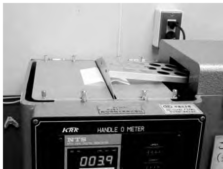
図1 ハンドルオメータによる柔らかさの測定
