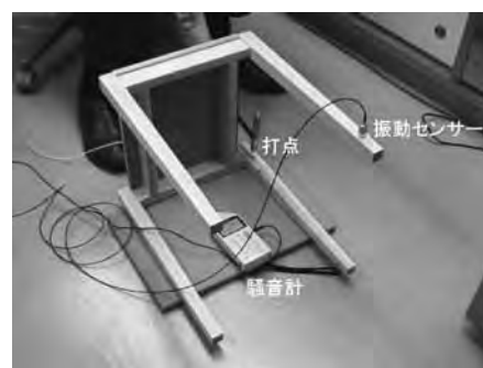
図2 インパルスハンマによる打音検査
