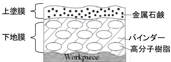
図1 2液2層型潤滑皮膜の構造概念図
