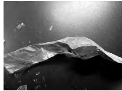
図10 環境劣化加速試験後による多層フィルム (フィルムD) の剥がれ
