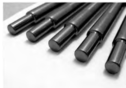
図1 新コーティングを施したダイカスト金型部材（鋳抜きピン）
