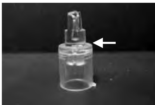
図1 割れトラブルを生じたヒンジ(白矢印部分の割れトラブル)
