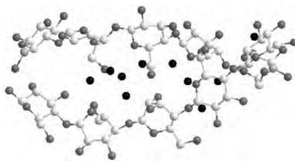
図11 セルロース分子間に存在する包接水のモデル図。 (薄灰色；炭素、濃灰色；酸素(セルロース由来)、 黒；酸素(包接水由来)。ただし、水素原子は省略。)
