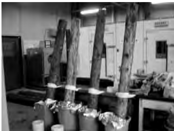
図1 生丸太の乾燥負圧を利用した薬液注入法
