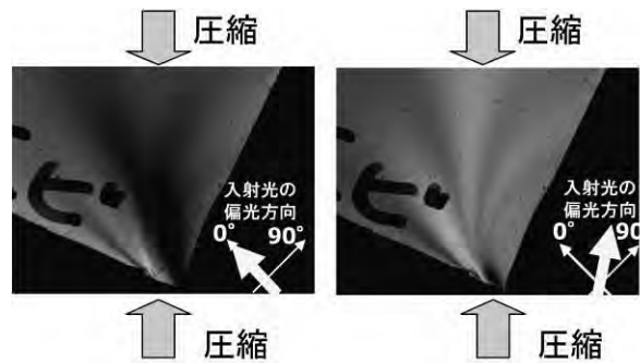
図3 透明塩化ビニル平板における光弾性実験観察画像の入射直線偏光状態(図中矢印)に対する依存性。図の上下方向から圧縮している。
