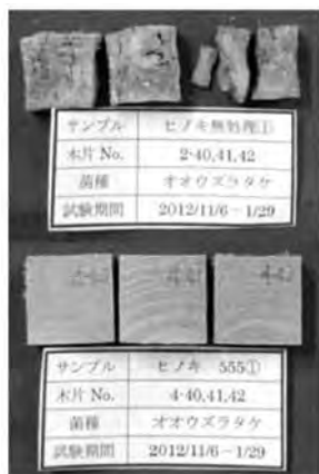
図4 抗菌操作結果 (基材:ヒノキ、供試菌:オオウズラタケ 上段:ブランク、下段:薬液注入材)
