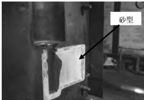
図5 金型に組み込んだ砂型
