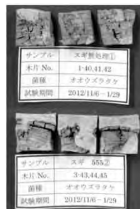
図3 抗菌操作結果（基材：スギ、供試菌：オオウズラタケ 上段：ブランク、下段：薬液注入材）
