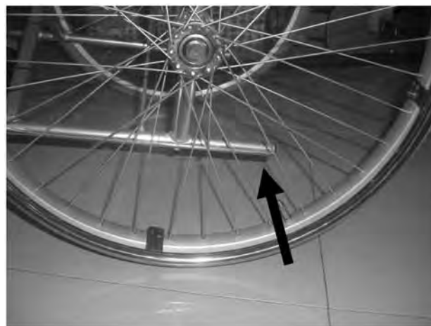
図1 車椅子の後方の転倒防止用具の取付部分
