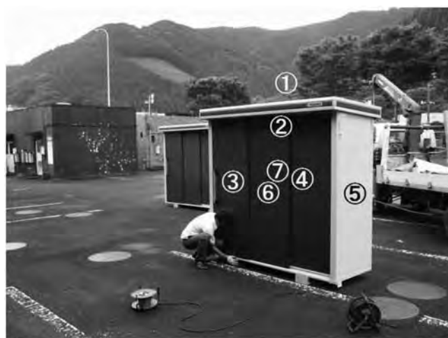
図1 鋼製物置と温度計測箇所
