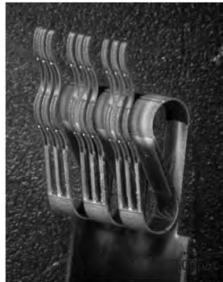
写真5 3連成形での形状ばらつきの抑制
