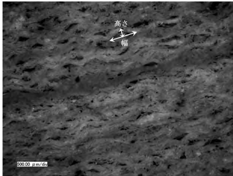
写真1 トイレットロールの断面方向からの観察画像（175倍）
