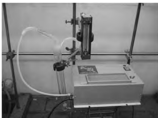
写真2 オゾン処理試験装置 (ワンパス方式)
