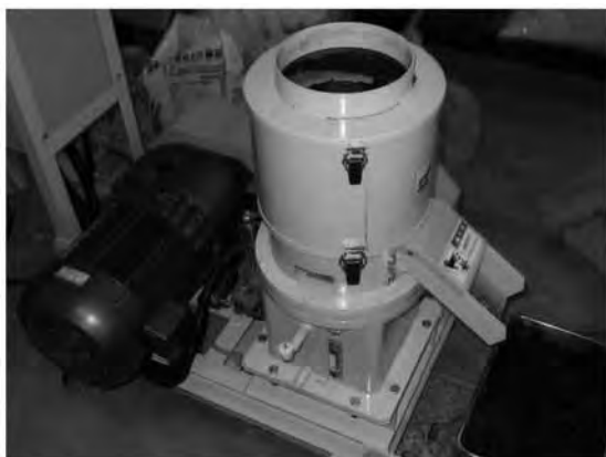
写真1 コーヒー飲料残渣のペレット成形機の様子
