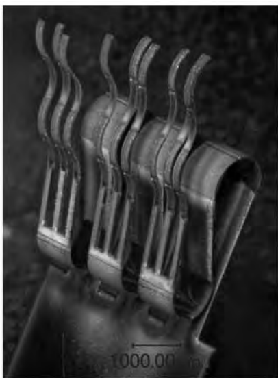
写真4 3連成形での自由端形状ばらつき
