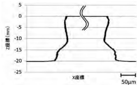
図7 リブの高さ方向の形状プロファイル
