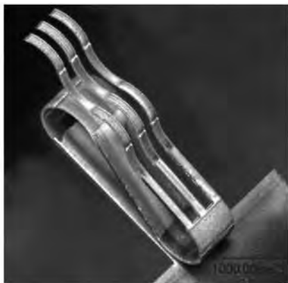
写真3 つなぎ部による形状ばらつきの抑制
