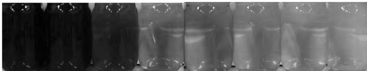
写真3 有機性色素排水のオゾン処理による色の変化（左から0～7時間後）
