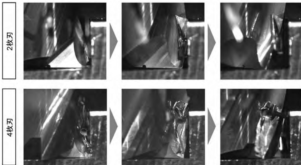
図3 切りくず排出状況
