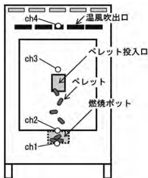
図1 燃焼試験における温度測定箇所 ch1：燃焼ポット底部、ch2：燃焼ポット上部、 ch3：燃焼炉中央、ch4：温風吹き出し口手前
