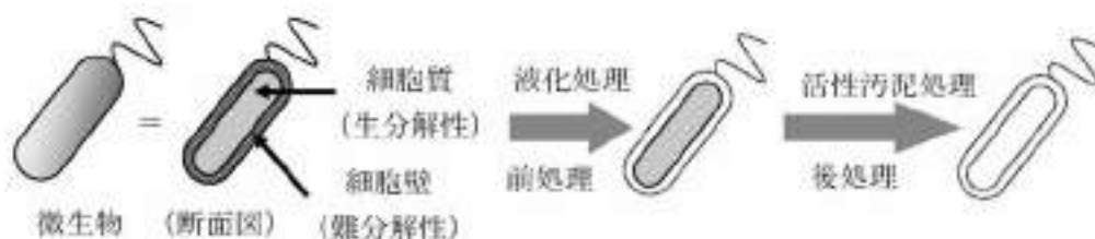
図2 余剰汚泥減容化の仕組み
