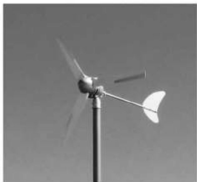
写真1 小型風力発電機
