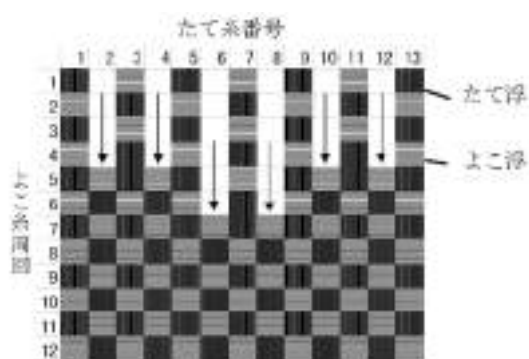
図2 たて糸挿入時の組織図（平織）
