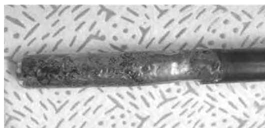
図4 2h試験後の窒化処理品浸漬部
