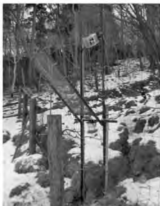
図6 捕獲実験時の自動閉鎖ゲート設置例
