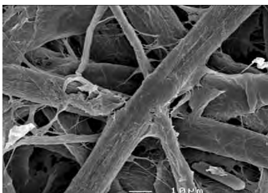
写真2 リサイクル5回目のパルプ繊維表面のSEM像
