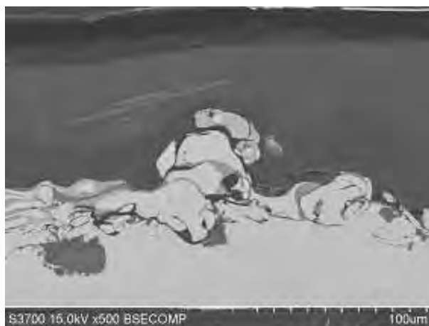
図2 現行品断面SEM観察 (下層の白いのが金属、上層がフッ素樹脂)
