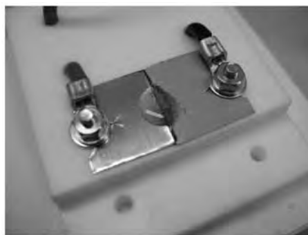
図1 電解腐食促進実験における接触反応部分の拡大図
