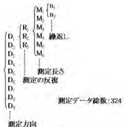
図6 ステップゲージ測定の順序
