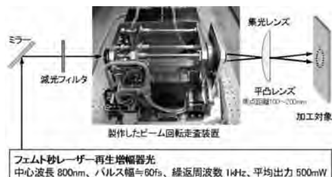
図5 ビーム回転走査装置の実証加工実験
