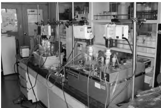
写真 4つの発酵槽を使用したメタン発酵実験の様子
