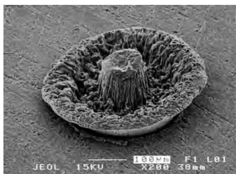
図4 円走査でのかしめ接合の例
