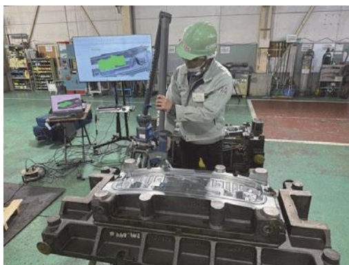
▲プッシュ型での計測 多関節アーム型3Dスキャナの活用例
