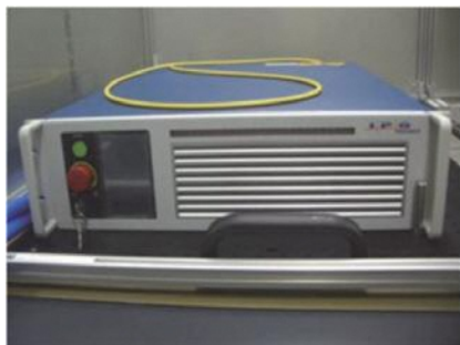
▲波長2μm帯ファイバーレーザー 主な用途：透明樹脂の溶着
