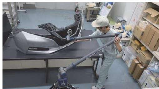
▲プッシュ型での計測 多関節アーム型3Dスキャナの活用例
