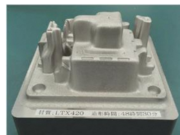
水管入りダイカスト金型の造形例
