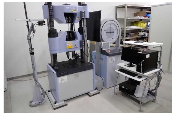
図 油圧式万能材料試験機 (令和6年度導入)
