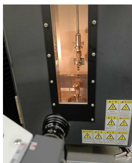
写真 恒温槽内引張試験状況
